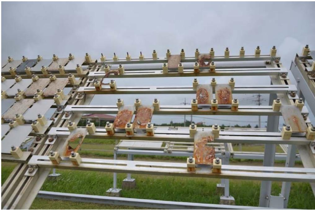
左の写真は、ステンレス板の暴露実験の様子です。ステンレスも様々な種類があり、すべてが錆びないわけではありません。下の写真はFRP(繊維強化プラスチック)の暴露実験の様子です。車のバンパーや船舶、一般住宅のベランダ防水など、幅広い分野で使われています。
